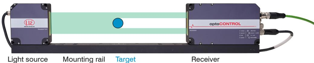
Fig. 2.1: The optoCONTROL 2700 Sensor
