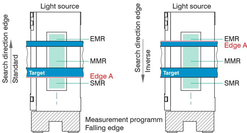
Fig. 2.3: Edge Assignment with Falling Edge Measuring Program
